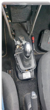
Console déposée, levier accessible. Photo Dav72 (p.12)
