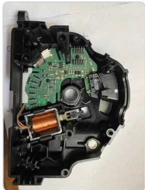
Boîtier ouvert : bobine en bas à gauche, carte verte, switch à droite de l'axe. Photo pmachat (p.17)
