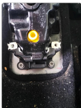
Fixations du boîtier au plancher. Photo POULET BASQUAISE (p.17)
