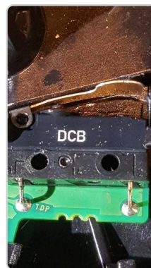
Le switch d'origine en gros plan, avec sa languette. Photo DOM Electro (p.9)
