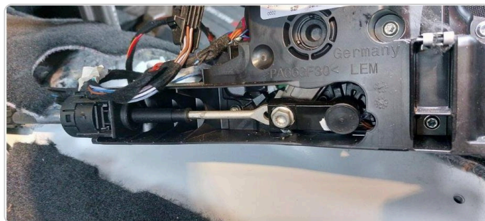
Le câble de commande sous le boîtier : repérez la position de l'écrou avant de desserrer. Photo Dav72 (p.12)
